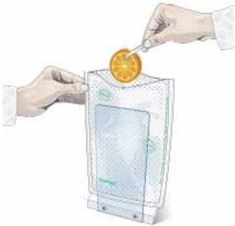
Colocar la muestra sólida en una bolsa estéril **BagPage®** o **BagFilter®**.
