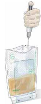
Pipetear el filtrado con **BagPipet®**. La filtración es instantánea y estéril. La muestra filtrada está lista para la siembra y el análisis.
